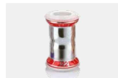
↑ GEBERIT MAPRESS ACERO AL CARBONO: MATERIAL DEL PRODUCTO 1.0034, 10215 Aprobado y verificado para sistemas de rociadores húmedos por VdS y FM Approvals (entre otros) y apto para usarse en tuberías de agua para extinción húmeda de incendios de conformidad con DIN 14462.
