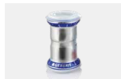
↑ GEBERIT MAPRESS ACERO INOXIDABLE: MATERIAL DEL PRODUCTO 1.4401 Aprobado y verificado para sistemas de rociadores húmedos y secos por VdS y FM Approvals (entre otros) y apto para usarse en tuberías de agua para extinción húmeda y seca de incendios de conformidad con DIN 14462.
